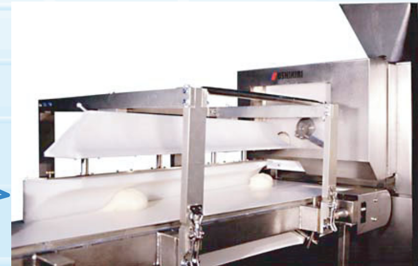
上図はシングル分割&1列丸め（ワンタッチ切換ラウンダバー付き）を示す。 Drawing above shows Single cut-off Divider & Single channel Rounder with One-touch Swivel rounder bar.
