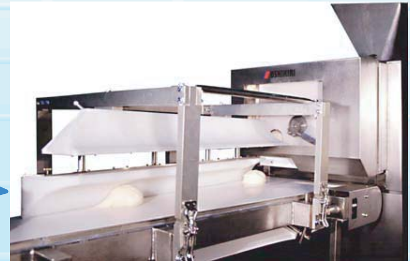
上図はシングル分割&1列丸め（ワンタッチ切替ラウンダバー付き）を示す。 Drawing above shows Single cut-off Divider & Single channel Rounder with One-touch Swivel rounder bar.
