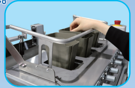
在入口料斗周围 设置有紧急停止把手。 降低把手会使机械停止。
