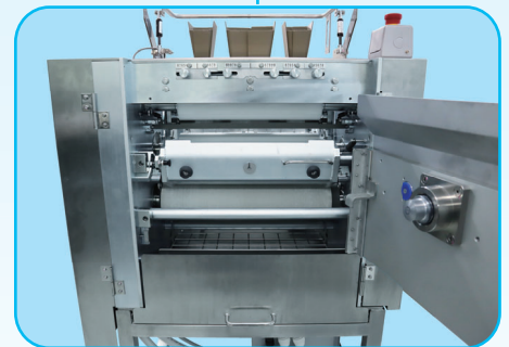
后面的盖板可以打开， 能轻松维修滚轮。 下面装有拉出式的接粉盘。
